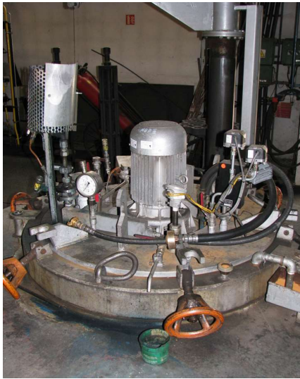
Obr.č. 1 – Šachtová pece RSHZM
